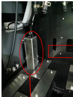
Esta parte detectará la superficie superior del medio.
