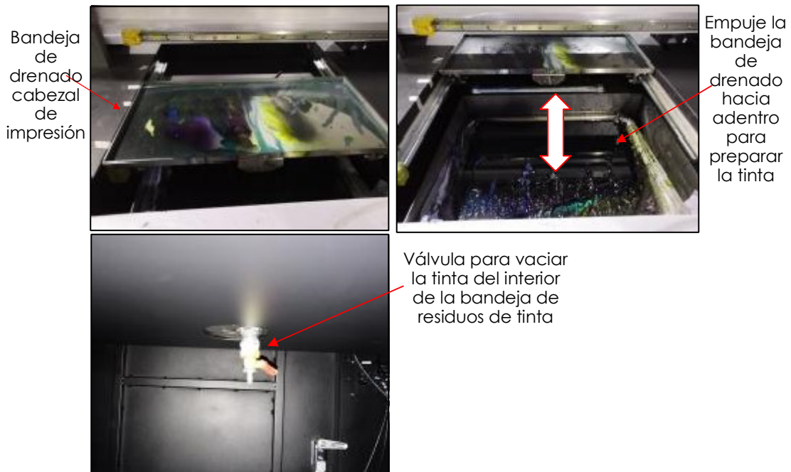
Estación de mantenimiento de cabezales de impresión
